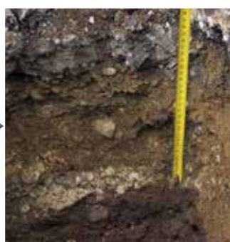
Săpături de testare și analize de laborator pentru a realiza rețeta corectă (testul adecvării)
