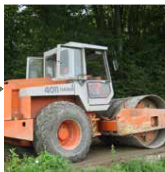
Compactare cu un conținut optim de apă pentru obținerea unui rezultat (de compactare) bun
